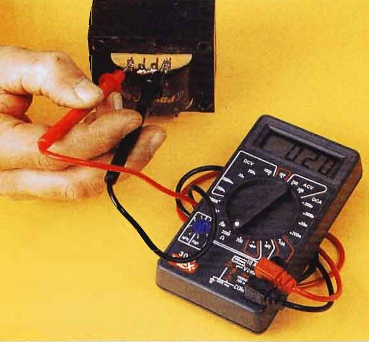
**Il tester è utile per verificare se un trasformatore funziona ed è indispensabile per effettuare misure sui morsetti prima di collegare fra loro due o più trasformatori.**
