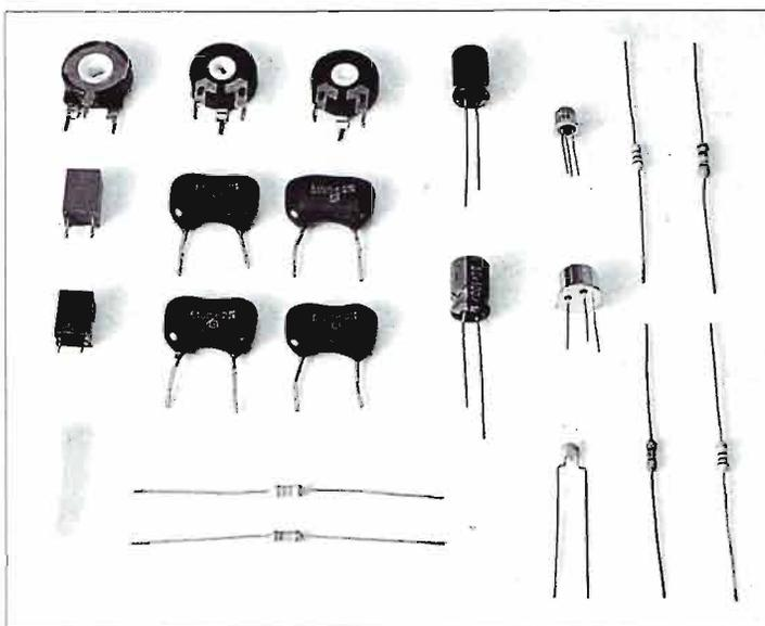
**I componenti necessari alla realizzazione, salvo i due transistor, sono tutti resistenze e condensatori. Nella foto manca l'interruttore, esterno al circuito.**
