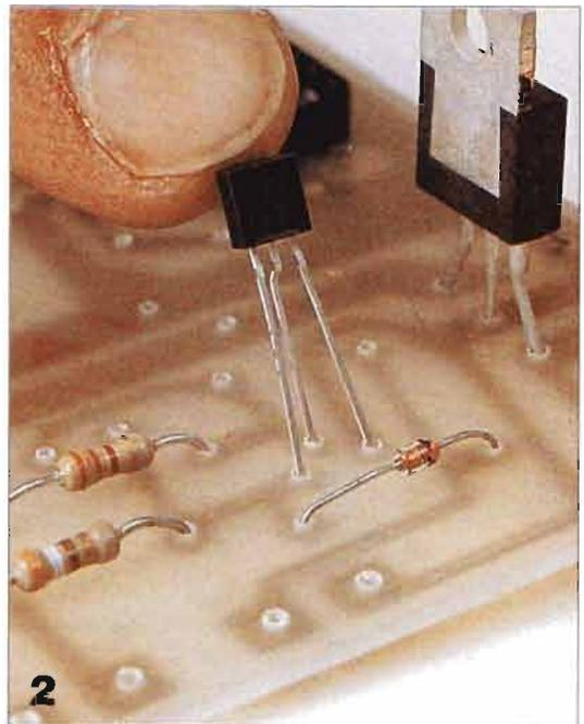
**2:** TR1, insieme a D1 e D2, produce la sequenza di impulsi logici che commuta l'integrato IC2 dalla fase di registrazione a quella di riproduzione. Si monta con la faccia piatta rivolta verso D1 e quindi verso l'esterno della bassetta.
